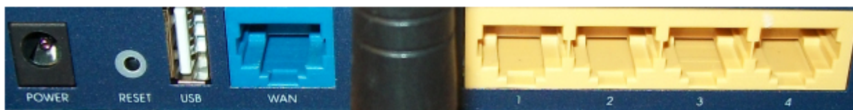
Рис. 3. Задняя панель беспроводного маршрутизатора TL-WR1043ND
