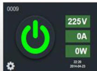
Графическое представление розетки: показания при включенном реле, с отключенной нагрузкой.
