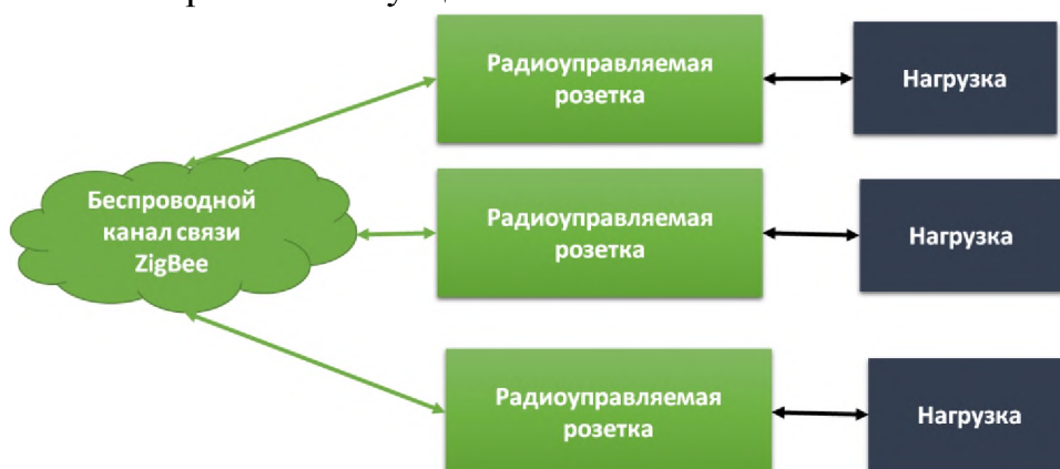
Рисунок 6 – Структурная реализация подсистемы управления электричеством Возможен вариант совместной реализации подсистем учёта потребляемой электроэнергии и управления электричеством в целях повышенной безопасности:
