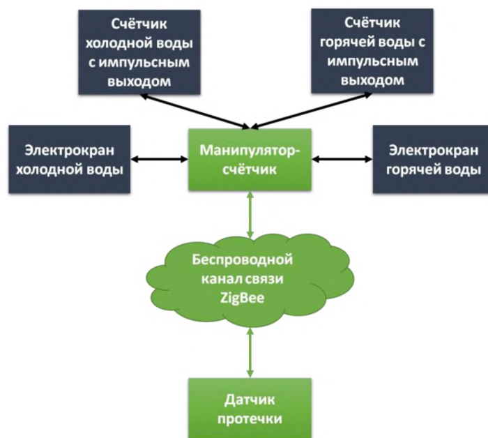
Рисунок 3 – Структурная реализация общего учёта потребления воды Индивидуальный учёт , как и общий, реализуется через манипуляторы-счётчики следующим образом: в систему общего учёта добавляется уникальная метка, которая закрепляется за пользователем (сколько потребителей воды – столько меток).
